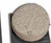
Calce idraulica naturale - NHL espansione pastiglia \approx 10\%
